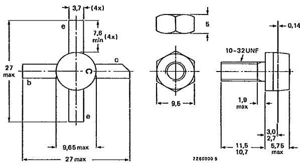
Torque on nut: min. 1,5 Nm
