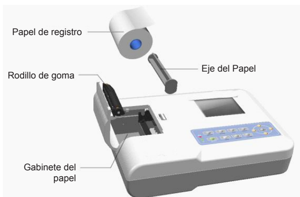
Figura 6-1 Instalación del papel de registro
