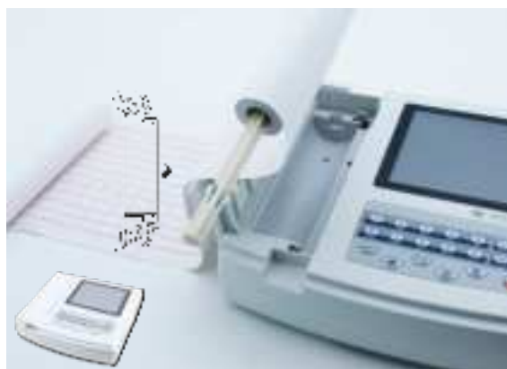
Figura 6-1 Instalación del papel de registro
