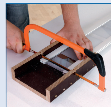
Zuschneiden der Profile auf die benötigte Länge.
