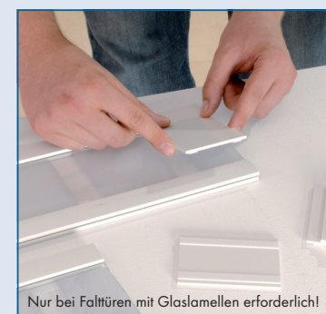
Abschlussblenden mit doppelseitigem Klebeband unten in die gekürzten Glaslamellen einkleben.
