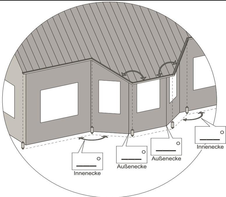
Sonderecken mit zusätzlicher Neigung benötigen Sie z.B. bei Dachgauben oder Anbauten mit schrägem Dach, die keine rechteckige Grundfläche haben. Tragen Sie bitte die benötigten Gradzahlen der Winkel in die entsprechenden Kästchen ein. Wenn Ihr Anwendungsfall nicht unserem Beispiel entspricht, fügen Sie bitte Ihrer Bestellung eine separate Skizze bei.
