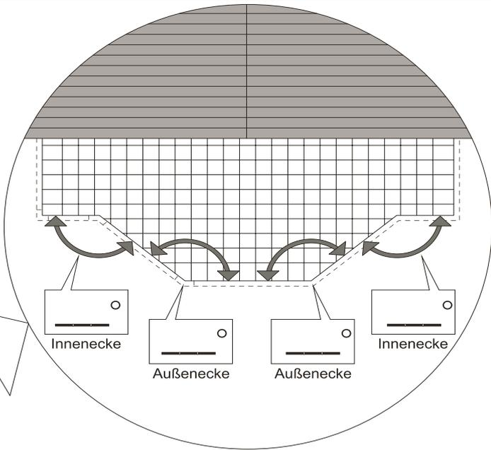
Sonderecken in ebener Ausführung benötigen Sie z.B. bei Balkonen oder Anbauten mit Flachdach, die keine rechteckige Grundfläche haben. Tragen Sie bitte die benötigten Gradzahlen der Winkel in die entsprechenden Kästchen ein. Wenn Ihr Anwendungsfall nicht unserem Beispiel entspricht, fügen Sie bitte Ihrer Bestellung eine separate Skizze bei.
