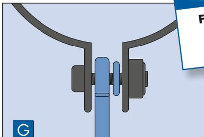
Als „Losschelle“ führt sie das Fallrohr in der Mitte oder am unteren Ende. Dabei werden Ringschraube und Unterlegscheibe zwischen die Laschen der Rohrschelle montiert. So kann sich das Rohr in der Schelle bewegen und Längenänderungen infolge von Temperaturschwankungen ausgleichen.
