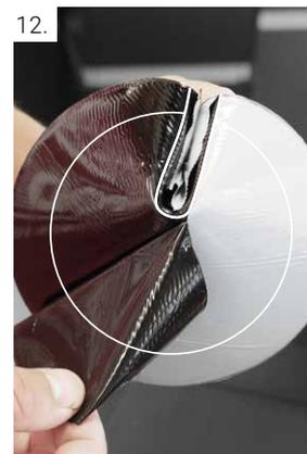
Anschließend Folie bis auf den Bereich der Quetschfalte entfernen.
