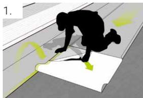
1. Nach ausreichendem Ablüften der Flächengrundierung Abdichtungsbahnen mit einer Überlappungsbreite von 50 mm bzw. 80 mm bei EPS Dämmstoffen ausrollen.
