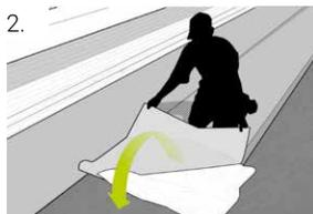
2. Gleichmäßiges, faltenfreies Zurückklappen des ersten Meters der Bahn mit beiden Händen.
