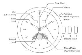
CROWN POSITION 2: QUICK OPERATION - DATE (COUNTERCLOCKWISE) / MOON PHASE (CLOCKWISE) CROWN POSITION 3: TIME/DAY SETTING (CLOCKWISE)
