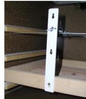
Die Bruthorde in das Gerät schieben und mit der Schraube in das Langloch des Halters einhängen. Sind alle Horden befestigt Flügelschraube (4) anziehen.
