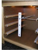
Halter (5) für die Bruthorden auf das Gestänge stecken und mit der Flügelschraube (4) befestigen. (hier Strebe)
