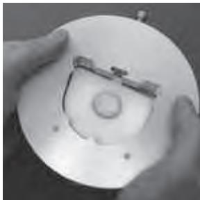
Introduzca la placa de zócalo desde abajo en el portaplaca. Presione ahora primero la entalladura frontal de la placa de zócalo contra el perno de resorte. Encolar a continuación la cola de milano de forma dorsal y apretar el tornillo de fijación a mano.
