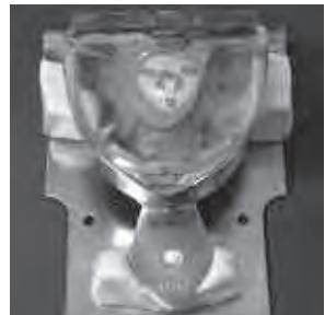
Inserire ed abbassare la coda di rondine della piastra di posizionamento trasparente (sporgenze rivolte verso l'alto) nell'apposita guida della lamiera portaimpronte.
