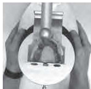
Premendo contemporaneamente i due pulsanti di azionamento, la posizione della piastra viene fissata elettronicamente e, nel contempo, viene effettuata la foratura.
