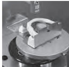
I due perni metallici situati sul lato superiore del disco portapiastre si inseriscono nei due fori della lamiera portaimpronte.
