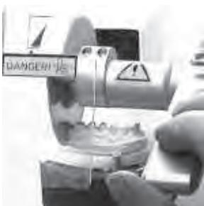
Sockelplatte in den Modelltisch der DIACUT-Modellsäge (171800) einspannen. Modelltisch entsprechend der Sägeschnittführung ausrichten. Angepeilten Sägeschnitt ausführen.
