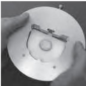
Introduire, par en dessous, la plaque de soclage à l'intérieur du porte-plaque en commençant par pliquer l'encoche frontale de la plaque contre la tige montée sur ressort. Ensuite, engager la queue d'aronde postérieure puis serrer à la main la vis de fixation correspondante.
