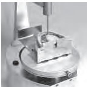
Plattenaufnahme mit Trägerblech auf den Magnettisch auflegen.
