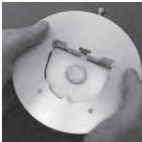
Inserire la piastra zoccolo da sotto nel disco portapiastre. Prima premere l'intaglio frontale della piastra zoccolo contro il perno di fissaggio del disco portapiastre. Dopodiché, inserire la coda di rondine. Stringere a mano la vite di fissaggio.
