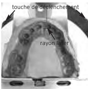
Mettre la foreuse en marche à l'aide du commutateur situé sur le devant de l'appareil. Le témoin lumineux vert s'allume. Activer le laser en appuyant sur l'une ou l'autre des deux touches de déclenchement. Définir ensuite la position de forage en orientant le faisceau en conséquence.
