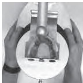
El alojamiento de la base plana queda fijado de forma electromagnética mediante pulsación simultánea de las dos teclas de desenganche, activando al mismo tiempo el ciclo de taladrado.
