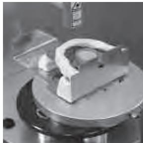
Los dos pivotes metálicos en el lado superior del portaplaca engarzan en los dos agujeros de la chapa de soporte.
