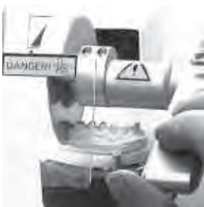
Fixer la plaque de soclage sur le plateau porte-modèle de la scie à modèles DIACUT (Réf. 171800). Positionner ensuite le plateau par rapport au trait de scie prévu puis scier.
