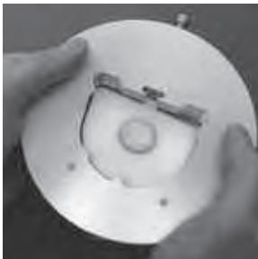
Sockelplatte von unten in den Plattenhalter einsetzen. Zuerst die frontale Kerbe der Sockelplatte gegen den Federbolzen drücken, dann den Schwalbenschwanz dorsal einrasten. Fixierschraube von Hand anziehen.
