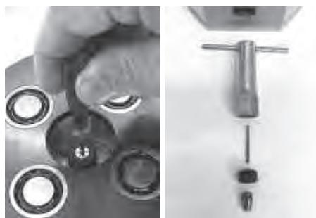
El taladro se apoya en el centro axial sobre un tornillo de cabeza ranurada. El tornillo es bajado mediante rotación a la derecha (diámetro de perforación más reducido), subiéndolo mediante rotación a la izquierda (diámetro de perforación más ancho). El extremo del pin sobresale correspondientemente más o menos de la placa de zócalo.
