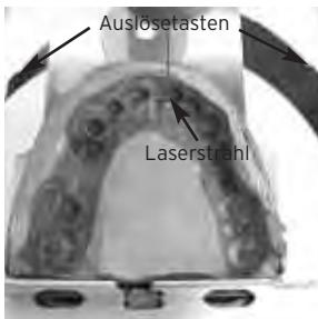
Hauptschalter an der Gerätefront einschalten (grüne Kontrolllampe brennt). Laser durch drücken einer der beiden Auslösetasten aktivieren. Die Bohrposition mit Hilfe des Laserstrahls anpeilen/ festlegen.
