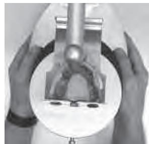
Durch gleichzeitiges Drücken beider Auslösetasten wird die Plattenaufnahme elektromagnetisch fixiert und der Bohrzyklus ausgelöst.
