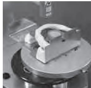
Die beiden Metallzapfen auf der Oberseite des Plattenhalters greifen in die beiden Bohrungen des Trägerbleches.
