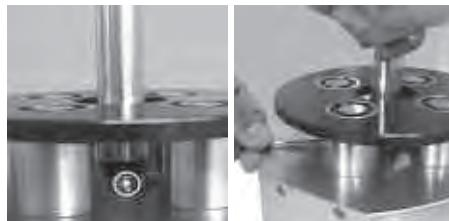
Netzstecker ziehen. Haltestift seitlich in ein Loch der Bohrachse stecken. Mit Rohrsteckschlüssel Überwurfmutter entgegen dem Uhrzeigersinn lösen. Defekten Bohrer nach Lösen der Überwurfmutter entfernen.
