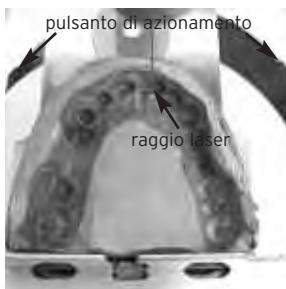
Azionare l'interruttore di rete sul lato frontale (si accende la spia verde). Attivare il laser premendo uno dei due pulsanti di azionamento. Determinare il punto di foratura con l'aiuto del raggio laser.
