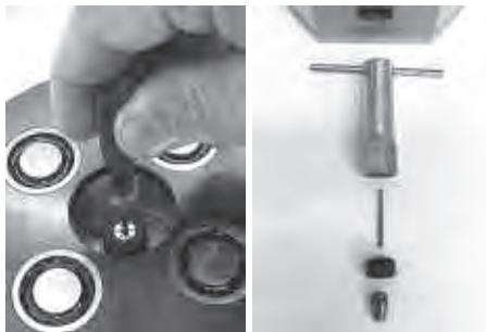
Le foret repose sur une vis à tête fendue placée au centre. Pour régler la profondeur de forage, tourner cette vis dans le sens horaire pour l'abaisser ou dans le sens antihoraire pour la relever. Selon le réglage effectué, les pins dépasseront plus ou moins du socle.
