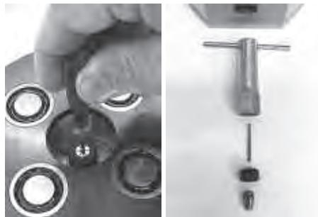
La fresa è posizionata al centro dell'asse su una vite con intaglio. Girando la vite a destra, questa si abbassa ed il foro sarà più stretto, girandola a sinistra, il foro sarà più largo. A seconda della regolazione, il perno sporgerà più o meno dalla piastra zoccolo.
