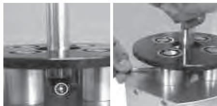
Estrarre la spina dalla presa di corrente. Infilare la spina di fissaggio lateralmente in un foro dell'asse di foratura. Con la chiave a tubo allentare il dado a risvolto in senso antiorario. Dopodiché, rimuovere la fresa difettosa.
