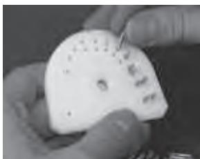
Prendre la plaque de soclage Giroform® et la tenir dans la main de façon à ce que ses ergots Split regardent vers le bas. Insérer ensuite les pins dans les trous de la plaque par leur partie conique, en les tenant par leur tête (partie rétentive du pin).
