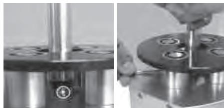
Desenchufe el aparato de la red. Introduzca a continuación el perno de fijación lateralmente en un agujero del eje de taladrado. Destornille ahora la tuerca de racor en el sentido contrario de las agujas del reloj, utilizando para ello la llave tubular hexagonal. Retire el taladro defectuoso, una vez destornillada la tuerca de racor.
