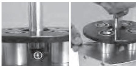
Débrancher l'appareil. Insérer latéralement la tige de blocage dans un trou de l'axe de forage. Avec la clé à pipe, dévisser l'écrou (sens contraire des aiguilles d'une montre). Après avoir ôté cet écrou, retirer le foret défectueux.
