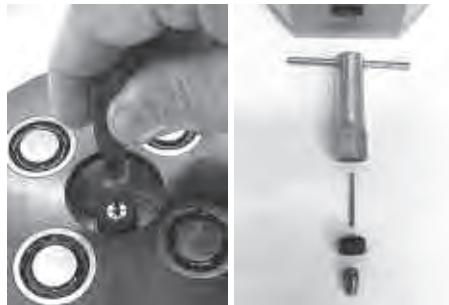
Der Bohrer liegt im Achsenmittelpunkt auf einer Schlitzschraube auf. Durch Rechtsdrehung wird die Schraube abgesenkt - engeres Bohrloch, durch Linksdrehung angehoben - weiteres Bohrloch. Entsprechend weit oder gering ragt das Pinende aus der Sockelplatte.
