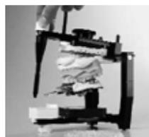
Positionnez le modèle maxillaire dans les mordus de la fourchette occlusale. Mettez la le contre-plaque dans la partie supérieure de l'appareil de plâtrage. Vérifiez l'espace demandé entre le modèle et la partie supérieure, le cas échéant réglez-le. (Meulez la base du modèle si cela est nécessaire et plâtrez en deux temps si un grand espace est demandé).
