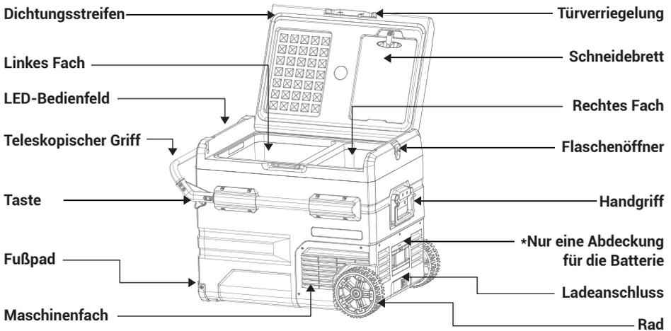
\*Auf beiden Seiten der Teleskopstange befinden sich Knöpfe, die Sie gleichzeitig drücken müssen, um die Stange zu ziehen.
