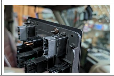
Install the new switch bezel
