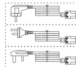
Cavo di alimentazione con spina Euro Schuko o cavo di alimentazione con spina AUS o Cavo di alimentazione UK
