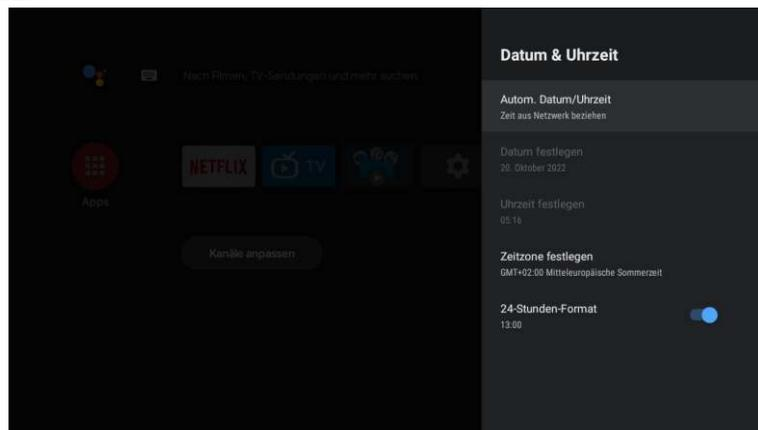
**Automatisches Datum & Uhrzeit-** Drücken Sie die ▲/▼-Taste, um die Option auszuwählen, und drücken Sie die OK-Taste, um das Untermenü aufzurufen. (Optional: Netzzeit verwenden, Aus)
