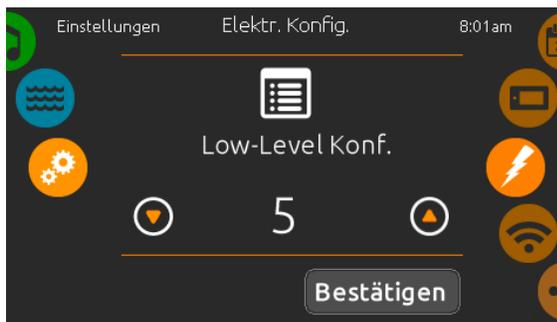
Bitte beachten Sie, dass bei Anwendung von 2 Spa-Paketen in einem System (z.B. einem Swimspa) die Konfiguration der Haupteinheit den Betrieb einer zweiten Einheit (Slave-unit) unterstützt. Wenn die Konfiguration eine solche Swimspa-Installation nicht unterstützt, kehrt das in.k1000 nach ca. 45 Sekunden in das Konfigurationsmenü zurück. Die Konfiguration muss erneut vorgenommen werden.
