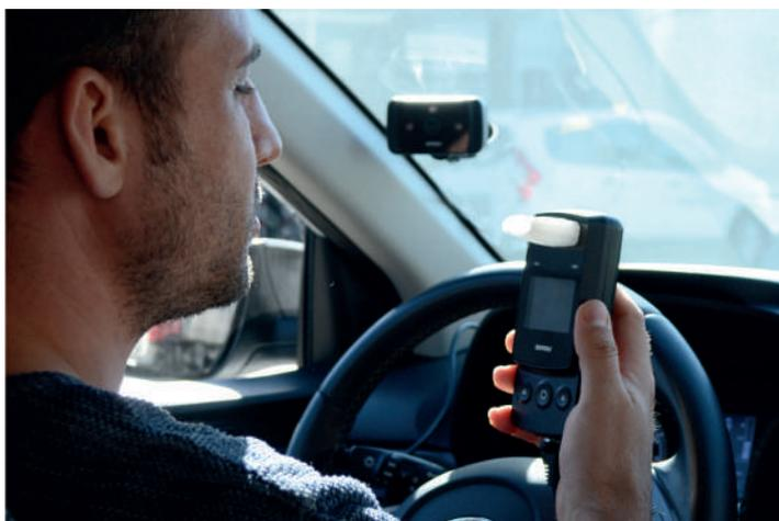
Quando se desea arrancar el vehículo mientras está estacionado, el sistema de interbloqueo le pide al conductor que sopla en el dispositivo de alcoholemia NAM-Lock. Si no se detecta consumo de alcohol en el conductor, se permite que el motor del vehículo funcione. Si se detecta consumo de alcohol, el motor del vehículo no arranca y/o actúa según las instrucciones definidas en el sistema (envío de información a la autoridad, envío de información a la comisaría, etc.).
