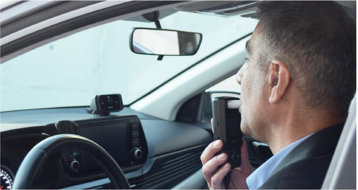
NAM-Lock es un sistema de control de bloqueo que se instala en el vehículo para garantizar la seguridad del tráfico y controla el uso de alcohol soplando del aliento del conductor, lo que contribuye a la eliminación sistemática de los riesgos de accidentes relacionados con el alcohol y la prevención de conducir bajo la influencia del alcohol.
