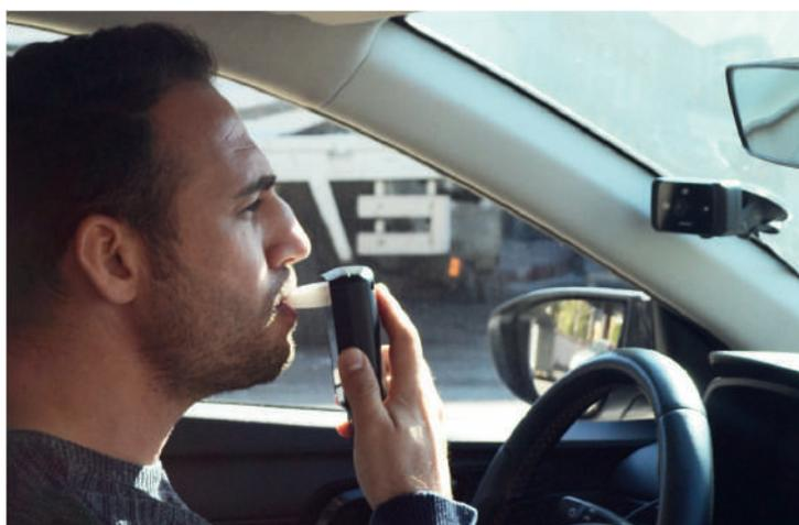
Mientras el vehículo está en movimiento, el sistema de interbloqueo solicita al conductor que sopla en el alcoholímetro NAM-Lock en tiempos indefinidos para realizar una inspección intermedia del conductor, si no se sopla dentro de un periodo determinado de tiempo, el sistema responderá a condiciones predefinidas.
