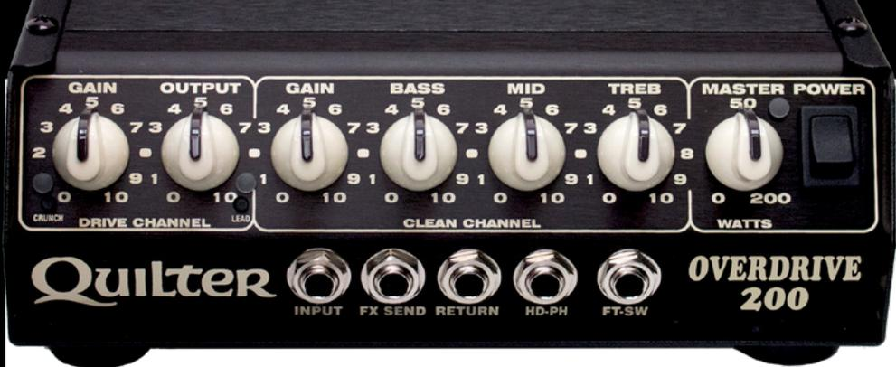
**TIPP:** Der Drive-Kanal kann auch als alternativer Clean- oder Edge-of-Break-up-Sound voreingestellt werden, indem Sie weniger Drive Gain und mehr Drive Output verwenden.
