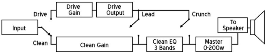
SIGNAL ARCHITECTURE: Ein schaltbarer DRIVE CHANNEL speist einen CLEAN CHANNEL mit einem MASTER, der die maximale Leistung einstellt.
