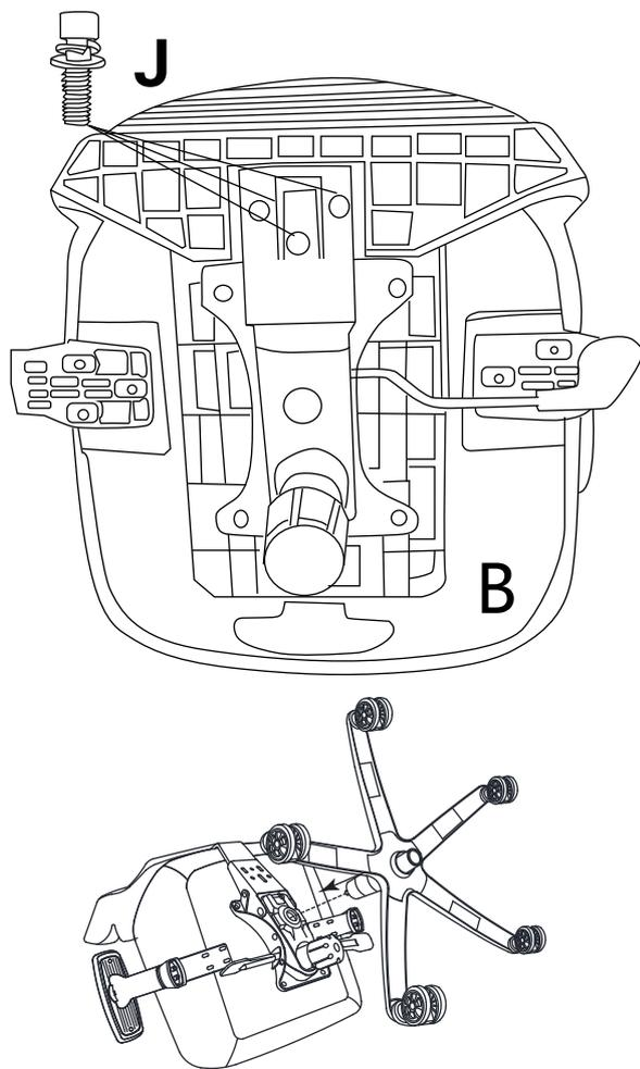
Com o conjunto posicionado e encaixado, insira os 3 parafusos e arruelas (J), apertando com as mãos. Com todos os parafusos posicionados, finalize apertando-os com a chave Allen (I).
