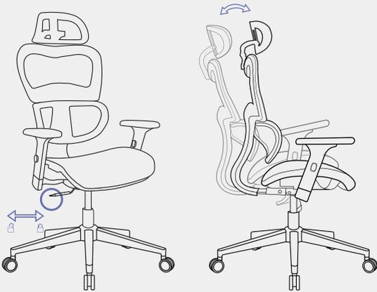
A Função Balanço (Rocking) permite inclinação em até 12°. Acione a alavanca esquerda do assento para cima e libere a função. Para deixar o mecanismo travado posicione a alavanca para baixo.
