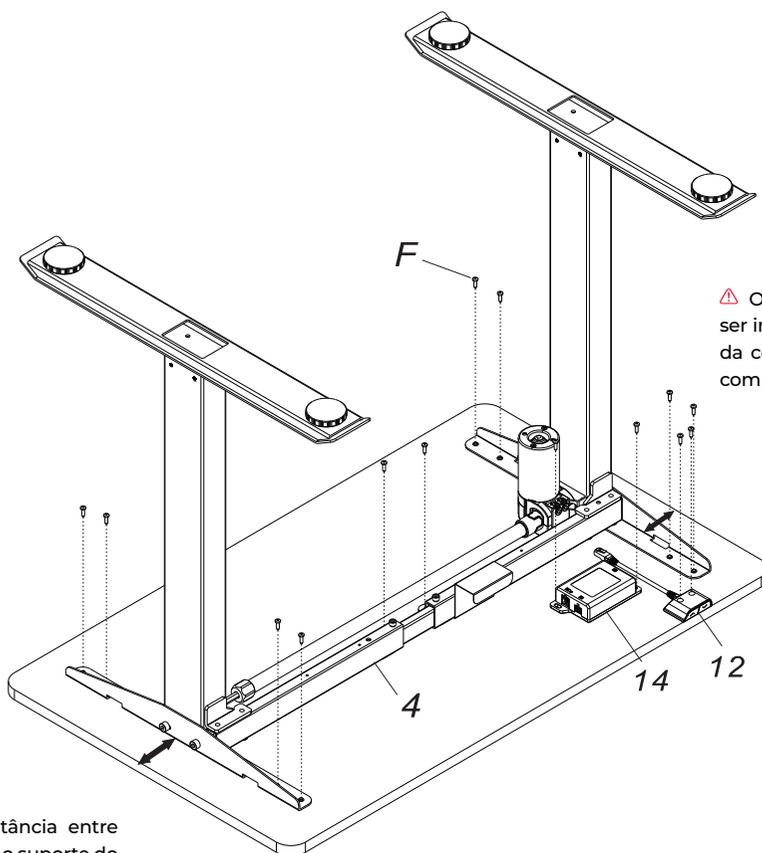
⚠ O display deve ser instalado ao lado da coluna elevatória com motor.
