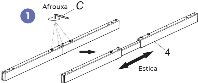
Com as pernas já montadas, instale a viga de suporte (4) nas colunas 2 e 3, parafuse-os utilizando os parafusos B, aperte-os com o auxílio da chave allen 5x5 (C).
