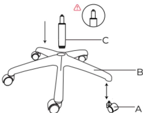
Pressione as 5 rodinhas (A) nos encaixes da base. Encaixe o cilindro de gás (C) na base (B).
