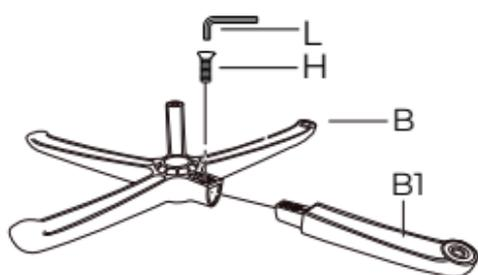
Apoie a base (B) sobre o plástico transparente protetor que acompanha o produto, para não arranhar. Encaixe, na base, a perna sobressalente (B1), e parafuse-a (H).
