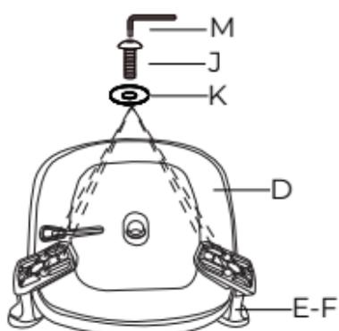
Posicione o assento (D) virado para baixo sobre uma superfície, encaixe os braços (E), depois de posicionados, insira os parafusos (J) e aruelas (K), aperte-os utilizando a chave Allen.
