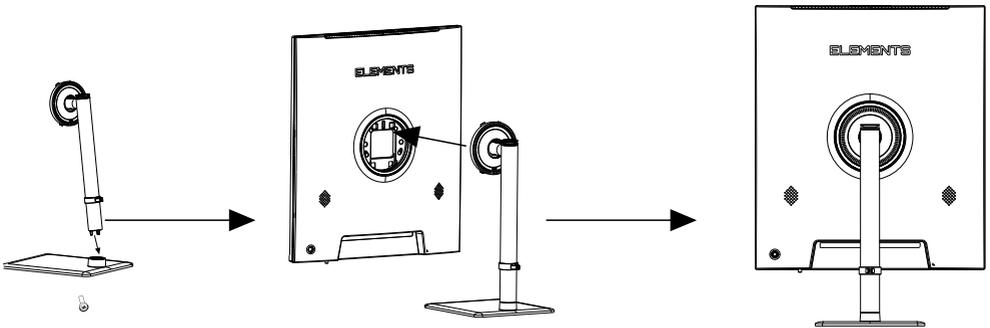
1. Encaixe a base (C) na haste de fixação (B), em seguida utilize uma chave de fenda para apertar o parafuso.
