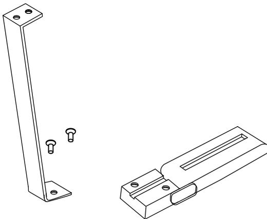
Posicione a base de Led (02) da sua luminária com o led virado para cima, encaixe o suporte metálico (03), e parafuse-o utilizando os parafusos 04.
