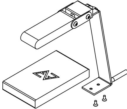
Posicione na base (01) o suporte metálico (03), já com a base de led (02) fixada. Parafuse-os utilizando os parafusos (04).
