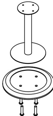
Posicione a base da sua banqueta Mush (01) sobre a parte inferior (onde estão localizadas as porcas) da estrutura metálica (02), e parafuse-as atravessando a base de madeira, utilizando os parafusos (5).
