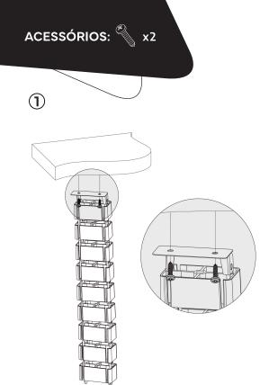
2 ADICIONE OU REMOVA SEÇÕES PARA AJUSTAR O COMPRIMENTO
