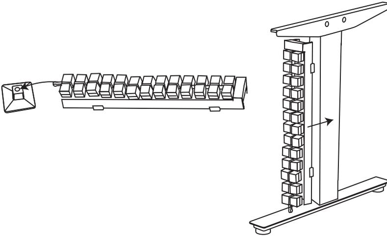
2 - Para passar os fios solte os parafusos, deixe as chapas de pressão presas à perna da mesa, posicione os fios e parafuse a "capa da calha" novamente (se atente para que os fios fiquem todos comportados na parte interna da calha).
