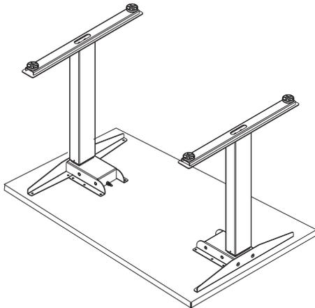
4 - Encaixe os fios à base de controle, e o controlador, fixe-os no tampo utilizando os parafusos G.
