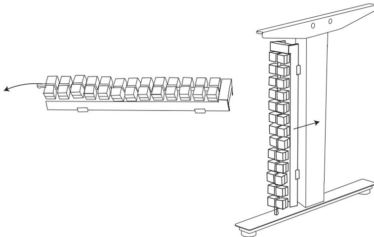
2 - Para passar os fios solte os parafusos, deixe as chapas de pressão presas à perna da mesa, posicione os fios e parafuse a "capa da calha" novamente (se atente para que os fios fiquem todos comportados na parte interna da calha).
