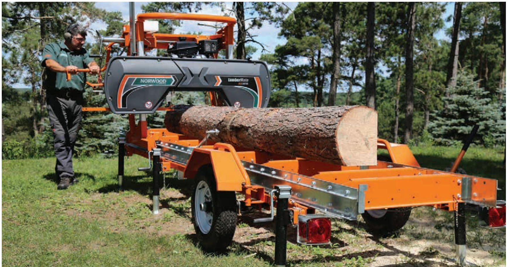
*Montré avec l'ensemble de mobilité, les vérins de support et l'ensemble de route pour système de mobilité (ailes, éclairage, faisceau de fils).
