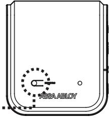
2. Mantén presionado el botón izquierdo del control remoto. La luz del estado pasará a color azul y después se apagará. Comprueba la vinculación presionando el mismo botón, el cual deberá activar la cerradura.
