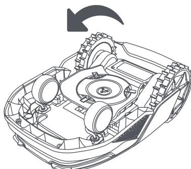
5. Ta bort knivbladet genom att rikta in hålet på knivbladet mot axeln.
