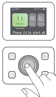
3. Vrid på vredet för att välja klippningsläge.
