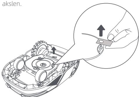
7. Tryk på knappen under skivebladet, og juster hullet i beholderen efter akslen for at fastgøre beholderne og bladene.
