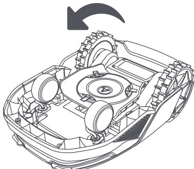
5. Verwijder het blad door het gat van het blad uit te lijnen met de as.
