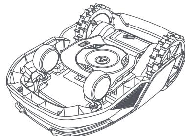
8. Se till att knivbladen kan rotera fritt.
