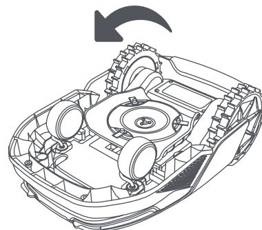
4. Reinig het lichaam, de messenschijf en het chassis van A1 met een slang.
