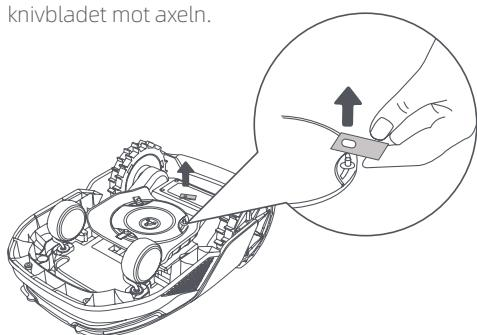
7. Tryck på knappen under bladskivan och rikta in hålet i hylsan med axeln för att fästa hylsorna och knivbladen.
