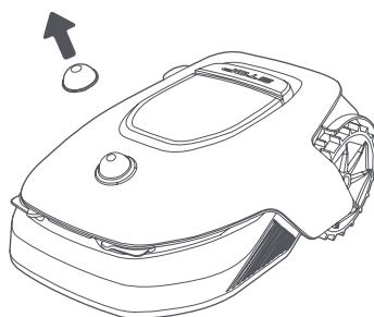
**3** Tryk på **Stop**-knappen for at åbne dækslet til kontrolpanelet. Hold **tænd/sluk**-knappen på kontrolpanelet nede i 2 sekunder for at tænde A1.
