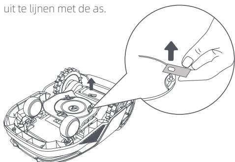
7. Druk op de knop onder de maaikop en lijn het gat van dehouder uit met de as om de houders en bladen vast te zetten.
