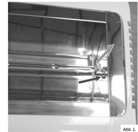
7. Die Schraube (Abb. L) vom Seitenreflektor entfernen und ihn nach oben vom Heizgerät abziehen.
