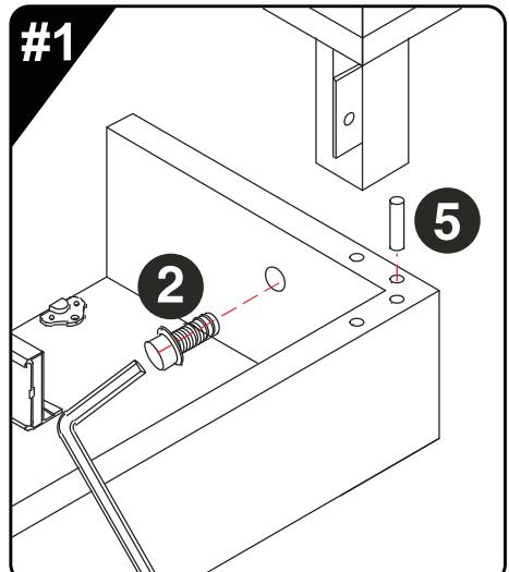
桌角的四个孔位塞入木钉后，桌子立柱对准孔位插入，拧入2号螺丝固定。
