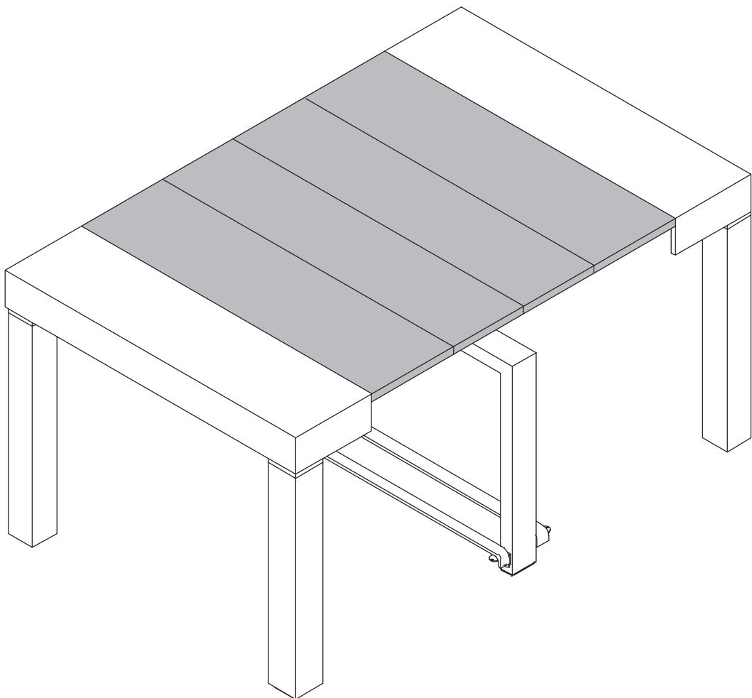
木板安装锁扣后，即可放上桌子框架，木板数量可根据使用需求放置。注意，每块木板两边都有一个凹孔和凸块，安装时注意摆放顺序。
