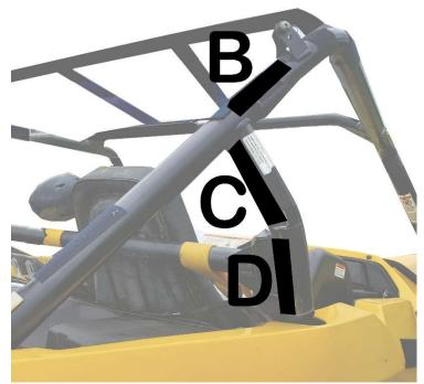
PLACE ADHESIVE VELCRO FOR LOWER STRIP F INSIDE THE CAB ON THE WALL OF THE SXS. PLACE ADHEISVE VELCRO FOR UPPER STRIP F ON THE TOP OF THE ROLL BAR AND WRAP F AROUND.
