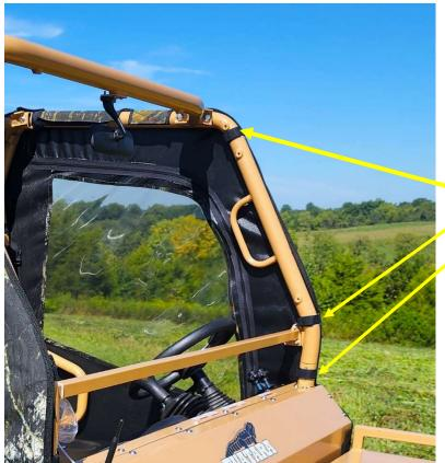
WRAP STRAPS AROUND THE ROLL BAR AND ATTACH TO THE OPPOSITE SIDE
