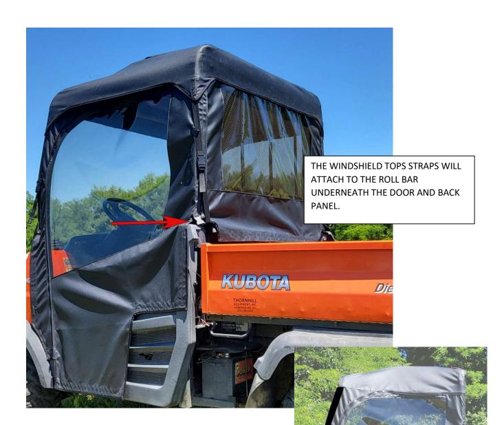
VELCRO FOR THE WINDSHIELD TOPS TABS IS SEWN ON TO THE FRONT OF YOUR DOOR KIT. PULL THESE TABS AROUND AND ATTACH TO THE DOOR.
