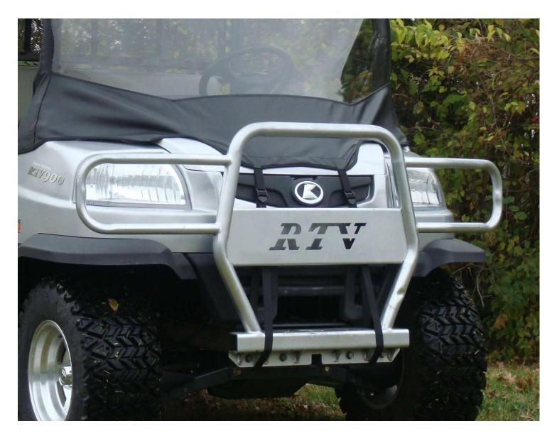
INSTALL THE WINDSHIELD TOPS BUMPER STRAPS BY WRAPPING THE STRAP AROUND THE BUMPER/CATTLE GUARD. PULL THE END OF THE STRAP THROUGH THE BUCKLES AND TIGHTEN
