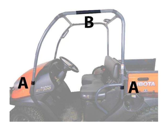
IF YOU HAVE A WINDSHIELD YOU WILL ATTACH THE DOUBLE-SIDED STRAPS FIRST. REINSTALL THE WINDSHIELD AND THEN ATTACH YOUR TOP CAP. THE TOP CAP WILL FIT DOWN OVER THE WINDSHIELD WITH THE TENSION STRAPS RESTING ALONG THE ROLL BAR OR ON THE WINDSHELD ITSELF. PICTURED BELOW.
