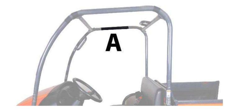
WRAP STRIPS OF ADHESIVE HOOK AROUND THE ROLL BAR AND ATTACH DOUBLE SIDED STRAPS. K
