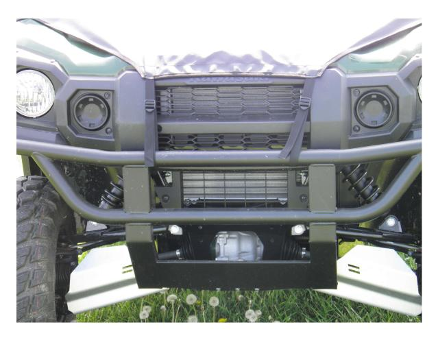
LOOP FRONT STRAPS DOWN AROUND THE CATTLE GUARD AND BACK UP THROUGH THE BUCKLE, PULL DOWN ON BOTH STRAPS AT THE SAME TIME TO TIGHTEN CAB TO FRAME.
