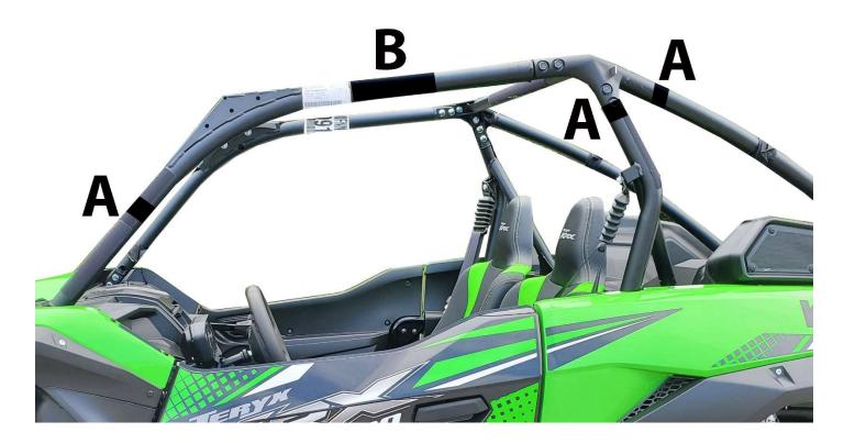
IF YOU HAVE A WINDSHIELD YOU WILL ATTACH THE DOUBLE-SIDED STRAPS FIRST. REINSTALL THE WINDSHIELD AND THEN ATTACH YOUR TOP CAP. THE TOP CAP WILL FIT DOWN OVER THE WINDSHIELD WITH THE TENSION STRAPS RESTING ALONG THE ROLL BAR OR ON THE WINDSHEILD ITSELF. PICTURED BELOW.
