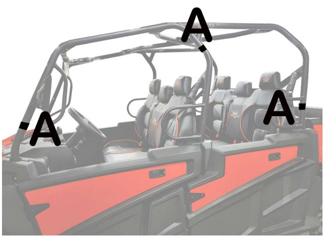
IF YOU HAVE A WINDSHIELD YOU WILL ATTACH THE DOUBLE-SIDED STRAPS FIRST. REINSTALL THE WINDSHIELD AND THEN ATTACH YOUR TOP CAP. THE TOP CAP WILL FIT DOWN OVER THE WINDSHIELD WITH THE TENSION STRAPS RESTING ALONG THE ROLL BAR OR ON THE WINDSHELD ITSELF. PICTURED BELOW.
