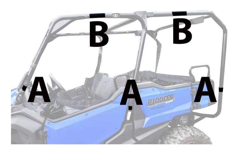
IF YOU HAVE A WINDSHIELD YOU WILL ATTACH THE DOUBLE-SIDED STRAPS FIRST. REINSTALL THE WINDSHIELD AND THEN ATTACH YOUR TOP CAP. THE TOP CAP WILL FIT DOWN OVER THE WINDSHIELD WITH THE TENSION STRAPS RESTING ALONG THE ROLL BAR OR ON THE WINDSHELD ITSELF. PICTURED BELOW.
