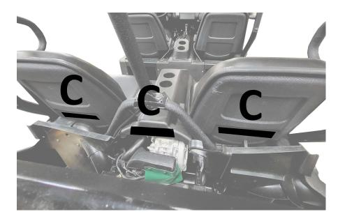
TO TIGHTEN THE TOP OF THE BACK PANEL PULL THE TOP STRAP TIGHT ON BOTH SIDES.
