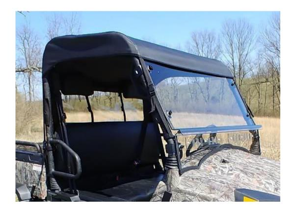
PICTURE SHOWS THE TENSION STRAPS ATTACHED TO YOUR TOP CAP. PULL THE TENSION STRAPS TO ADJUST THE POSITION OF YOUR TOP CAP.
