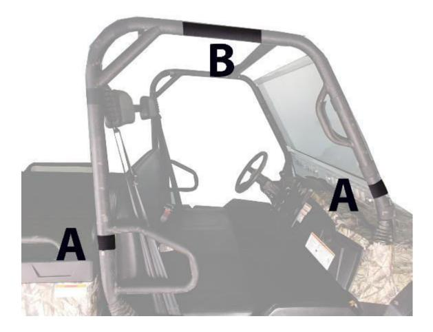
IF YOU HAVE A WINDSHIELD YOU WILL ATTACH THE DOUBLE-SIDED STRAPS FIRST. REINSTALL THE WINDSHIELD AND THEN ATTACH YOUR TOP CAP. THE TOP CAP WILL FIT DOWN OVER THE WINDSHIELD WITH THE TENSION STRAPS RESTING ALONG THE ROLL BAR OR ON THE WINDSHEILD ITSELF. PICTURED BELOW.
