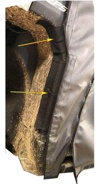
PULL TABS AROUND TO THE INSIDE OF THE FRONT WHEEL WELL
