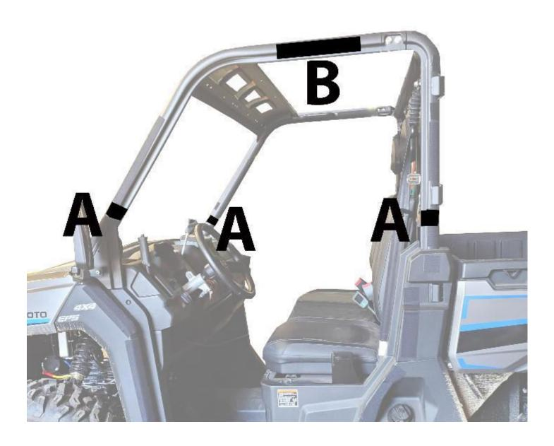
IF YOU HAVE A WINDSHIELD YOU WILL ATTACH THE DOUBLE-SIDED STRAPS FIRST. REINSTALL THE WINDSHIELD AND THEN ATTACH YOUR TOP CAP. THE TOP CAP WILL FIT DOWN OVER THE WINDSHIELD WITH THE TENSION STRAPS RESTING ALONG THE ROLL BAR OR ON THE WINDSHEILD ITSELF. PICTURED BELOW
