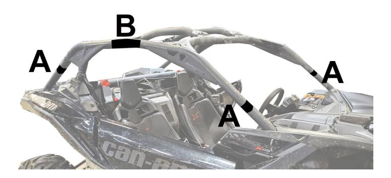
IF YOU HAVE A WINDSHIELD YOU WILL ATTACH THE DOUBLE-SIDED STRAPS FIRST. REINSTALL THE WINDSHIELD AND THEN ATTACH YOUR TOP CAP. THE TOP CAP WILL FIT DOWN OVER THE WINDSHIELD WITH THE TENSION STRAPS RESTING ALONG THE ROLL BAR OR ON THE WINDSHEILD ITSELF. PICTURED BELOW
