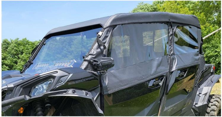
IF YOU HAVE A WINDSHIELD YOU WILL ATTACH THE DOUBLE-SIDED STRAPS FIRST. REINSTALL THE WINDSHIELD AND THEN ATTACH YOUR TOP CAP. THE TOP CAP WILL FIT DOWN OVER THE WINDSHIELD WITH THE TENSION STRAPS RESTING ALONG THE ROLL BAR OR ON THE WINDSHELD ITSELF. PICTURED BELOW.
