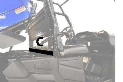
WRAP DOUBLE SIDED STRAPS AROUND THE ROLL BAR. FOR EXTRA HOLD.
