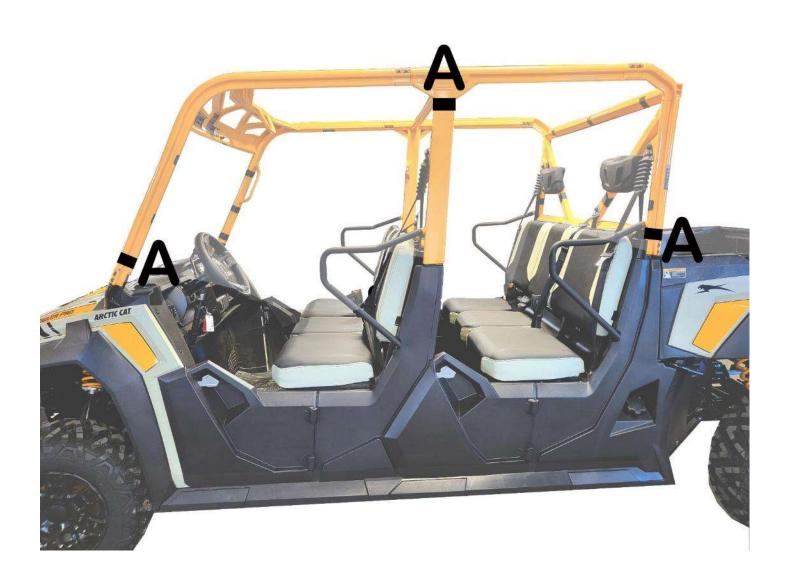
IF YOU HAVE A WINDSHIELD YOU WILL ATTACH THE DOUBLE-SIDED STRAPS FIRST. REINSTALL THE WINDSHIELD AND THEN ATTACH YOUR TOP CAP. THE TOP CAP WILL FIT DOWN OVER THE WINDSHIELD WITH THE TENSION STRAPS RESTING ALONG THE ROLL BAR OR ON THE WINDSHEILD ITSELF. PICTURED BELOW
