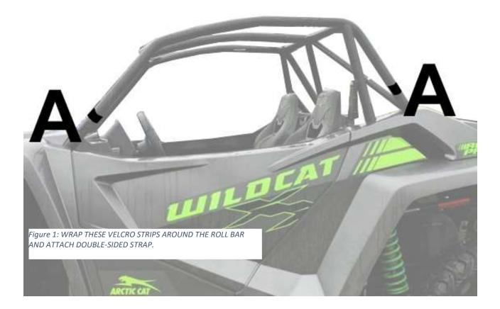
IF YOU HAVE A WINDSHIELD YOU WILL ATTACH THE DOUBLE-SIDED STRAPS FIRST. REINSTALL THE WINDSHIELD AND THEN ATTACH YOUR TOP CAP. THE TOP CAP WILL FIT DOWN OVER THE WINDSHIELD WITH THE TENSION STRAPS RESTING ALONG THE ROLL BAR OR ON THE WINDSHEILD ITSELF. PICTURED BELOW.
